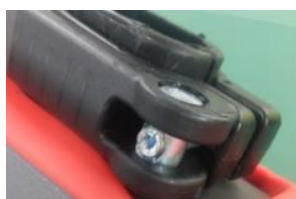
ネジが緩んだ状態
